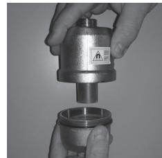
Chiudere la valvola di intercettazione in entrata al filtro defangatore. Aprire svitando in senso antiorario il vaso inferiore del filtro defangatore.
