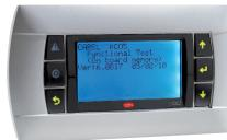
**Terminale grafico remoto:** replica tutte le funzionalità del display a bordo macchina. È costituito da un pannello grafico LCD con 6 pulsanti retroilluminati (da LED integrato) e da un cavo di collegamento (lunghezza 1,5m).
