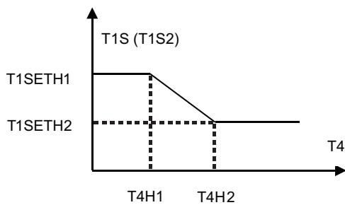
fig. 38 - Curva climatica 9 in modo riscaldamento
