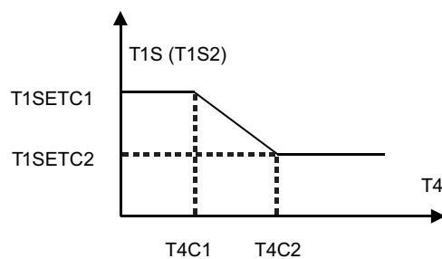
fig. 39 - Curva climatica 9 in modo raffreddamento
