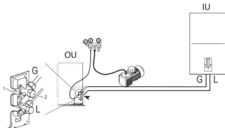
fig. 13 - Spurgo aria con pompa del vuoto
