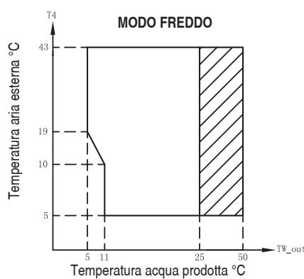
■ Campo di funzionamento con pompa di calore con possibile limitazione e protezione.
